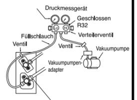
Zu Beginn des Pumpvorgangs die Konusmutter leicht lösen, um zu prüfen, ob Luft angesaugt wird. Anschließend die Konusmutter wieder festziehen.
