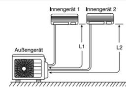
Die minimale Rohrleitungslänge für jede Inneneinheit ist 3m. Die maximale Rohrlänge für ein Innengerät beträgt 25m. ※ Zusätzliches Nachfüllen von Kältemittel ist nicht erforderlich.
