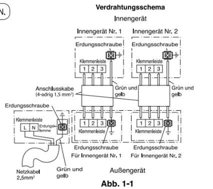
Im Gebäude befindlicher Erdungskabelanschluss zum Außengerät
