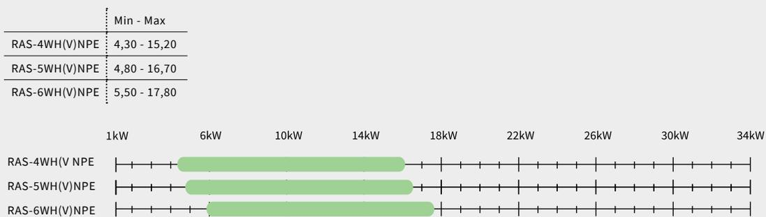
Heizleistungsbereich unter den Bedingungen: Wasserein- und -austritt: 30/35 °C; Außentemperatur: 7/6 °C (FK/TK).
