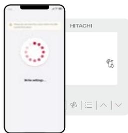
2 Öffnen Sie die airCloud Tap-App und halten Sie Ihr Telefon an die Kabelfernbedienung, um eine Verbindung herzustellen.
